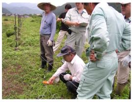
電気柵の電圧確保が不十分だったため、デジタル式の 電圧チェッカーを各隣保に導入し、定期的な電圧チェック 体制を確保。老朽化や接続部分の漏電が見られたこと から、折れにくいポールや扱いやすいクリップなど新型 の資材を導入した。
